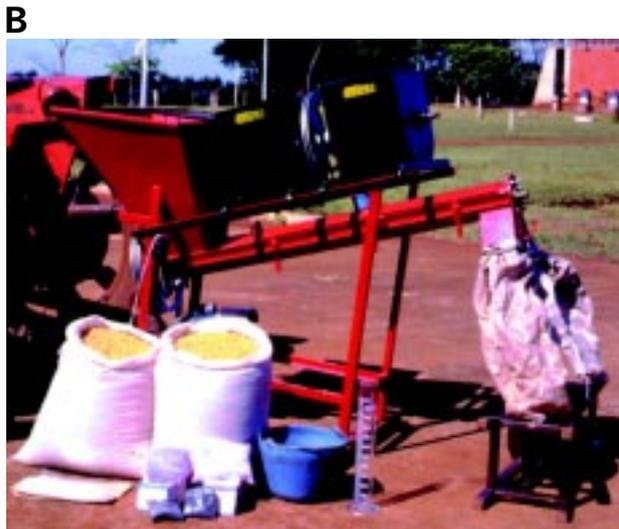
**FIG. 5.** Tambor rotatório (A) e máquina (B) utilizadas para tratamento de sementes e inoculação.
